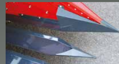
A kanálaszerű földelosztó hegyek kopásgátló acélból készültek.
