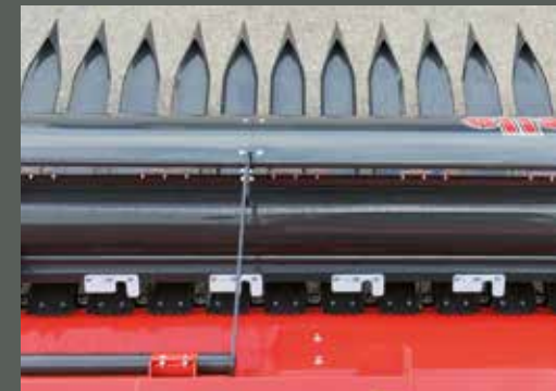
A kanálaszerű földelosztó hegyek kopásgátló acélból készültek.
